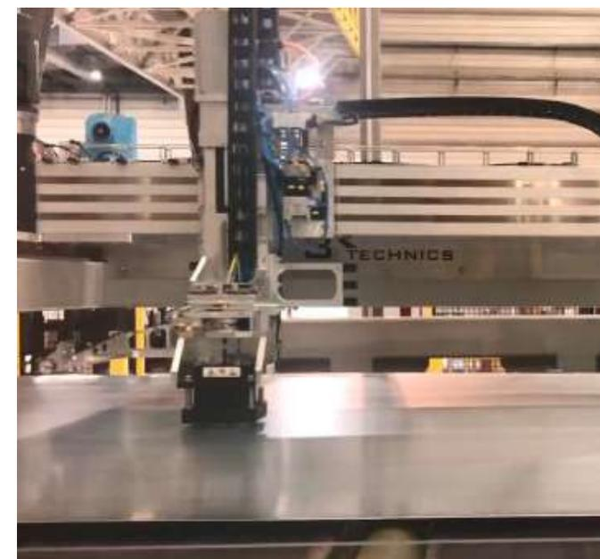
Sistema de control de espesor, propiedades mecánicas y marcación láser
